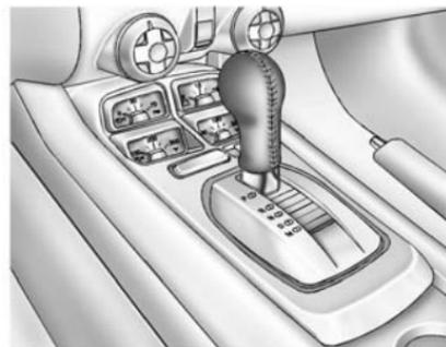
**P (stationnement):** Cette position bloque les roues arrière. C'est la meilleure position à utiliser pour
