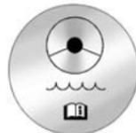
Le réservoir du liquide de direction assistée est sous le couvercle moteur du côté du conducteur vers l'avant du compartiment moteur. Se reporter à *Vue d'ensemble du compartiment moteur à la page 10-5*.
