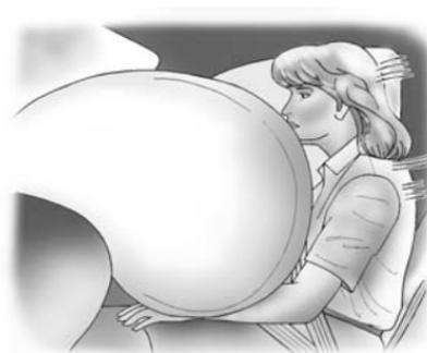
L'airbag frontal de passager extérieur avant se trouve dans le tableau de bord côté passager.
