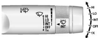
La manette d'essuie-glace/lave-glace avant se trouve sur le côté droit de la colonne de direction. Lorsque le contact est en position ACC/ACCESSORY (accessoires) ou ON/RUN (en fonction/marche), déplacer le levier d'essuie-glace pour sélectionner la vitesse de balayage.
