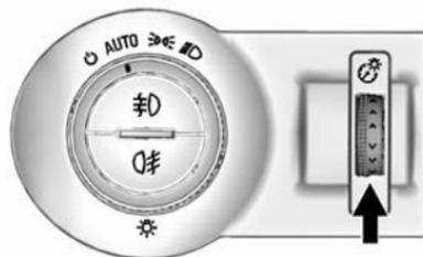
Cette fonction commande l'intensité de l'éclairage du tableau de bord.
