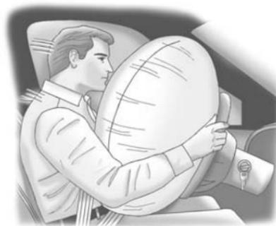
L'airbag frontal du conducteur se trouve au milieu du volant de direction.
