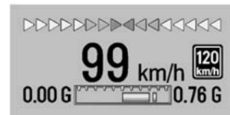
Les véhicules équipés d'un affichage à tête haute (HUD) peut également posséder des témoins de calage de changement de rapport à travers le haut de l'affichage. En approchant d'un point de changement de rapport, les rangées de lampes se rapprochent. Un changement de vitesse est nécessaire avant que les témoins ne se rejoignent au milieu de l'affichage. Si les témoins commencent à clignoter, vous avez dépassé le point de changement de rapport. Changer de rapport immédiatement.
