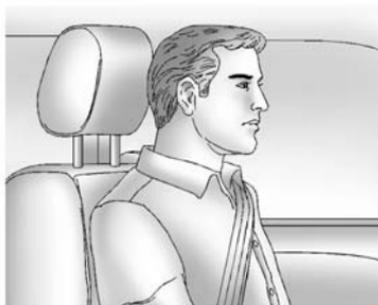
Si équipé des sièges de base, régler l'appuie-tête de sorte que sa partie supérieure arrive au niveau du haut de la tête de l'occupant. Cette position réduit les risques de blessure à la nuque lors d'un accident.
