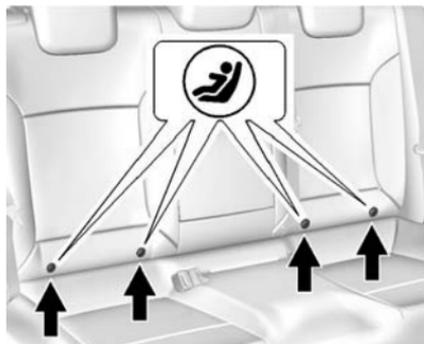
Les supports de fixation ISOFIX sont repérés par
