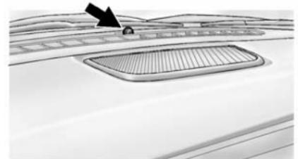
Un capteur de lumière du véhicule est au sommet du tableau de bord. Ne pas couvrir ce capteur, sinon le système s'active chaque fois que le contact est mis.
