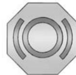
Le bouchon du réservoir de liquide d'embrayage/frein est doté de ce symbole. Le réservoir du fluide de
