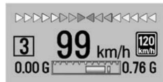
Les véhicules équipés d'un affichage à tête haute (HUD) possèdent également des témoins de calage de changement de rapport à travers le haut de l'affichage. En approchant d'un point de changement de rapport, les rangées de lampes se rapprochent. Un changement de vitesse est nécessaire avant que les témoins ne se rejoignent au milieu de l'affichage. Si les témoins commencent à clignoter, vous avez dépassé le point de changement de rapport. Changer de rapport immédiatement.
