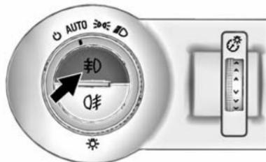
Le bouton des feux antibrouillard avant se trouve sur le commutateur d'éclairage extérieur, du côté extérieur de la colonne de direction.
