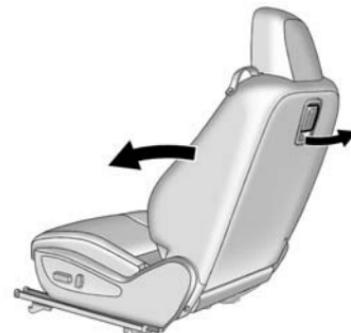
Pour accéder aux sièges arrière, lever le loquet de l'arrière du dossier de siège de conducteur ou de passager avant. Rabattre le dossier vers l'avant.
