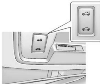
**Ouverture/Fermeture:** Maintenir enfoncé l'arrière ou l'avant du commutateur pour ouvrir ou fermer le toit ouvrant.
