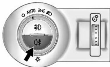
Le bouton du phare antibrouillard arrière se trouve sur la commande d'éclairage extérieur du côté extérieur de la colonne de direction.
