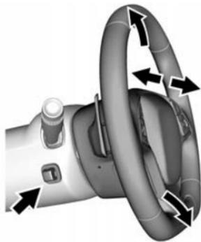
Appuyer sur la commande pour déplacer le volant de direction en position d'inclinaison ou télescopique vers le haut et le bas ou vers l'avant et l'arrière.
