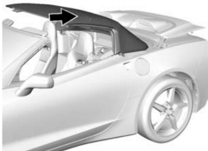
2. Lever et faire pivoter le toit amovible vers l'arrière en position de rangement complet.
