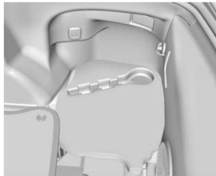
L'anneau de remorquage est situé sous le plancher de chargement, près de la roue de secours ou du kit de compresseur, selon l'équipement.
