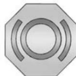
Le réservoir du maître-cylindre de freinage est rempli de liquide de frein DOT 3 approuvé par GM comme indiqué sur le bouchon du réservoir. Consulter *Vue d'ensemble du compartiment moteur* ↻ 247 pour connaître l'emplacement du réservoir.
