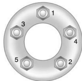
Serrer les écrous de goujon de roue fermement, en croix. Se reporter à *Capacités et caractéristiques* ↪ 348.
