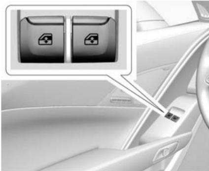
Les lève-vitres électriques fonctionnent lorsque le véhicule est en marche ou sur ACC/ACCESSORY (accessoires), ou quand le mode de prolongation de l'alimentation des accessoires (RAP) est activé. Se reporter à *Alimentation accessoires conservée* ⇨ 202.
