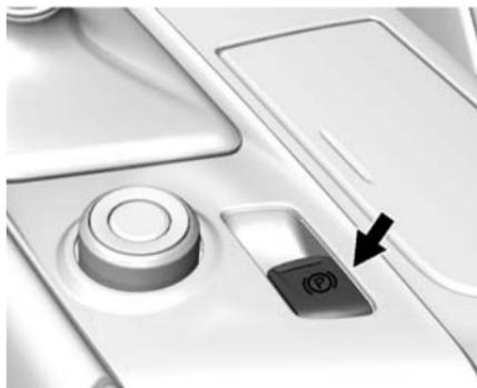
Le véhicule possède un frein de stationnement électrique. L'EPB peut toujours être activé, même si le contact est coupé. Pour éviter de décharger la batterie, éviter les cycles répétés du système de frein de stationnement électrique (EPB) quand le moteur ne tourne pas.
