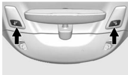
Les lampes de lecture se trouvent dans le vide-poches de pavillon. Les lampes s'allument lorsqu'une porte est ouverte. Lorsque les portes sont fermées, appuyer sur les boutons de lampe pour allumer chaque lampe.
