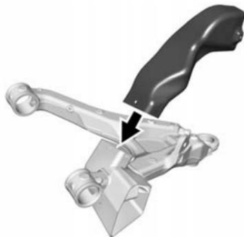
9. Positionner la conduite supérieure et la clipser en place dans les languettes sur l'ensemble de caisson d'air arrière.
