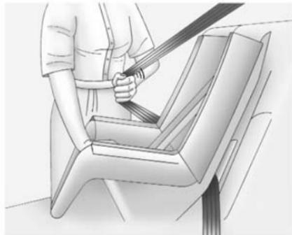
5. Tirer complètement la sangle thoracique hors de l'enrouleur pour engager le système de blocage. Lorsque le système de blocage de l'enrouleur est engagé, la ceinture peut être serrée, mais ne peut être tirée hors de l'enrouleur.
