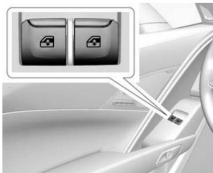
Les lève-vitres électriques fonctionnent lorsque le commutateur est en position contact ou ACC/ACCESSORY (accessoires) ou lorsque la prolongation de l'alimentation des accessoires (RAP) est active. Consulter *Alimentation accessoires conservée* ⇨ 202.
