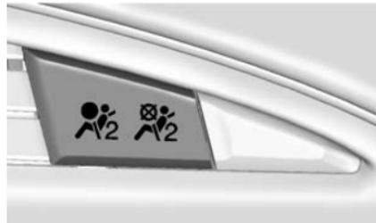
Le symbole d'activation/désactivation est visible pendant la vérification du système. À l'issue de la vérification du système, le symbole en fonction ou hors fonction est visible. Voir *Témoin de l'état de l'airbag passager* ⇨ 128.
