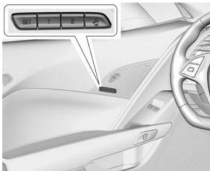
Sur les véhicules équipés, les sièges à mémoire permettent à deux conducteurs de mémoriser et rappeler chacun leur position de conduite et une position de sortie commune pour quitter le véhicule. Les positions d'autres équipements peuvent aussi être mémorisées, comme les rétroviseurs et le volant à réglage électrique. Les positions mémorisées sont reliées à l'émetteur RKE 1 ou 2 pour les rappels automatiques.
