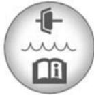
Le bouchon du réservoir de liquide d'embrayage est doté de ce symbole. Consulter *Vue d'ensemble du compartiment moteur* ⇨ 247 pour connaître l'emplacement du réservoir.
