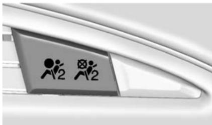
Lorsque le véhicule démarre, le témoin de statut de l'airbag de passager allumera le symbole d'activation/désactivation pendant quelques secondes à titre de test. Ensuite, après plusieurs secondes, le mot ON (marche) ou OFF (arrêt) ou le symbole correspondant du témoin sera allumé pour indiquer l'état de l'airbag frontal du passager extérieur avant.
