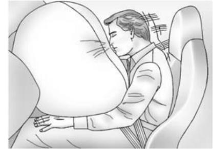
L'airbag frontal du passager extérieur avant se trouve dans le tableau de bord côté passager.
