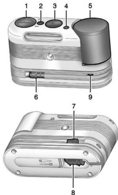
1. Commutateur (Produit d'étanchéité/Air ou air seulement).
