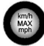
16. Si le pneu crevé a pu se regonfler à la pression de gonflage recommandée, décoller l'étiquette de vitesse maximale du bidon de produit d'étanchéité (5) et la placer à un endroit très visible. Ne pas dépasser la vitesse indiquée sur cette étiquette tant que le pneu endommagé n'est pas réparé ou remplacé.
