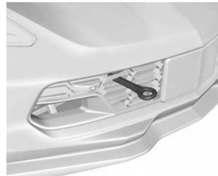
La douille d'œillet de remorquage avant est accessible à travers l'ouverture de la calandre.
