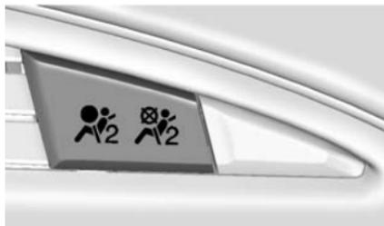
Le système de détection de passager désactive le coussin gonflable frontal de passager avant extérieur dans certaines conditions. Aucun autre coussin anti-chocs n'est affecté par le système de détection de passager. Consulter *Système de détection de passager* ⇨ 83.
