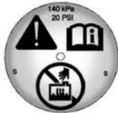
1. Lorsque le système de refroidissement, y compris le bouchon de pression et la durit supérieure, a refroidi, retirer le bouchon de pression.
