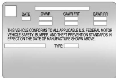
Une étiquette de certification spécifique à un véhicule est fixée au montant central du côté droit (montant B). Elle peut indiquer le poids maximal brut du véhicule, appelé le poids total en charge (PTC). Le PNBV comprend le poids du véhicule, de tous les occupants, du carburant et de la charge.
