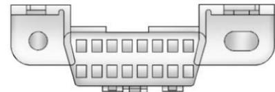
Le DLC se trouve sous le tableau de bord, à gauche du volant. Le branchement d'appareils n'étant pas utilisés pour effectuer un test d'inspection/maintenance des émissions ou pour une intervention sur le véhicule peut nuire au fonctionnement du véhicule. Consulter *Équipement électrique accessoire* ⇨ 246. Consulter le réparateur agréé si une assistance s'avère nécessaire.
