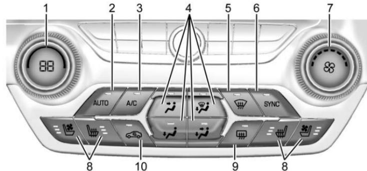
1. Contrôle de la température conducteur
