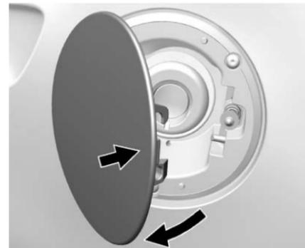
Pour ouvrir la trappe à carburant, pousser et relâcher le bord central arrière du volet. Le volet de carburant est bloqué lorsque les portes du véhicule sont verrouillées.
