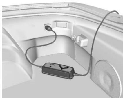
Certains véhicules disposent d'un ensemble d'entretien pour la batterie. Suivre les instructions fournies avec l'ensemble d'entretien de la batterie pour garder la batterie chargée lorsque le véhicule n'est pas utilisé. Brancher l'ensemble d'entretien de la batterie uniquement sur la prise d'alimentation des accessoires uniquement. La fonction prise d'alimentation des accessoires avant est désactivée lorsque le contact est coupé.
