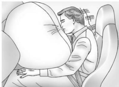
L'airbag frontal du passager extérieur avant se trouve dans le tableau de bord côté passager.
