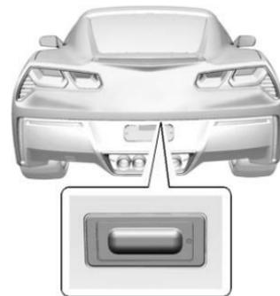
Appuyer sur le pavé tactile du coffre/hayon pour l'ouvrir si la télécommande RKE est à moins de 1 m (3 ft).
