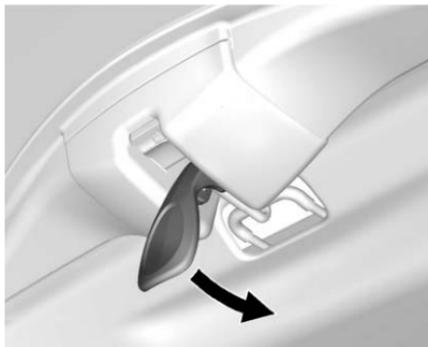
10. Pousser vers l'arrière et le haut sur la poignée de déverrouillage arrière pour introduire le crochet dans la boucle.
