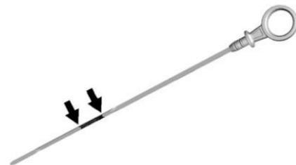
Si le niveau d'huile se situe en dessous de la zone hachurée à la pointe de la jauge, verser 1 L (1 qt) de l'huile recommandée par l'orifice de remplissage d'huile du réservoir, puis vérifier à nouveau le niveau. Voir «Sélection de l'huile moteur correcte» pour obtenir des explications sur le type d'huile à utiliser. Pour connaître la capacité d'huile du carter-moteur, voir *Capacités et caractéristiques* ⇨ 350.
