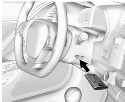
1. Placer la télécommande dans la pochette de télécommande de la colonne de direction, avec les boutons dirigés vers le haut et la base dirigée vers le côté passager.
