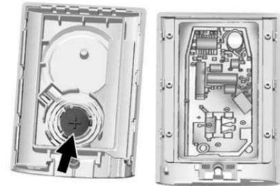
3. Retirer l'ancienne pile. Ne pas utiliser d'objet métallique.
