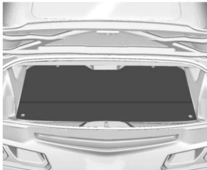
Lorsque la capote est levée, le séparateur de coffre peut être déboîté et laissé à plat pour augmenter l'espace de chargement du coffre.
