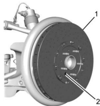
8. Poser le rotor (1) avec la fixation (2). Serrer au couple de 10 N•m (89 lb-po).
