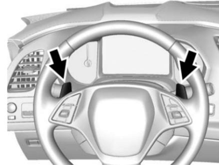
Lorsque le levier sélecteur est passé sur M (mode manuel), la boîte de vitesses passe en mode manuel. La boîte de vitesses maintiendra le rapport sélectionné jusqu'à ce qu'un changement de vitesse soit demandé. Les palettes du volant peuvent être utilisées pour passer au rapport de vitesse supérieur ou rétrograder. La palette plus (+) droite permet de passer au
