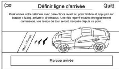
Pour définir la ligne d'arrivée, positionner le véhicule avec son pare-chocs avant sur le point de départ/arrivée. Dans le menu PDR, appuyer sur Définir ligne d'arrivée puis appuyer sur Marq. arrivée. Cette opération est possible quand le véhicule roule.
