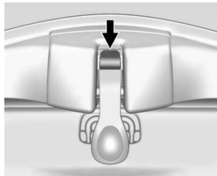
7. Appuyer sur le bouton situé sur l'avant de la poignée de déverrouillage arrière pour le déverrouiller. Le levier de loquet s'ouvre.
