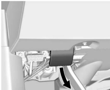
1. Tirer le levier de déverrouillage du capot à l'intérieur du véhicule. Il se trouve sous le tableau de bord, côté conducteur.
