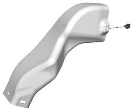
7. Positionner l'écrou en U sur la conduite supérieure.
