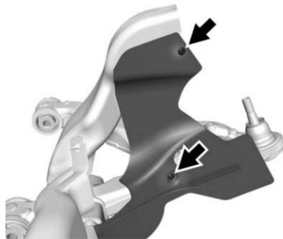
11. Poser le déflecteur de bras de suspension sur le bras de suspension inférieur à l'aide des vis auto-taraudeuses. Ne pas serrer à cette étape.
