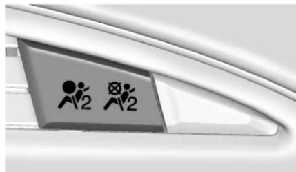
Le système de détection de passager désactive le coussin gonflable frontal de passager avant extérieur dans certaines conditions. Aucun autre coussin anti-chocs n'est affecté par le système de détection de passager. Consulter *Système de détection de passager* ⇨ 82.
