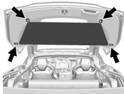
Fixer les boucles élastiques aux quatre coins du couvercle de chargement aux crochets des coins avant et arrière du hayon.
