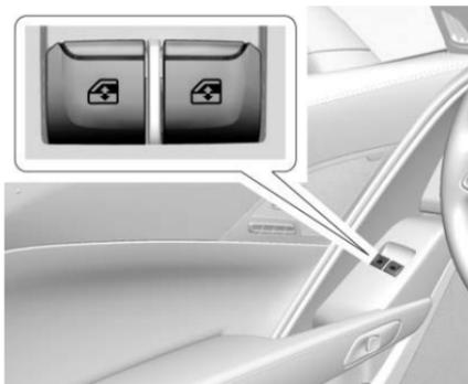
Les vitres fonctionnent lorsque le véhicule est en position ON/RUN (en fonction/marche), ACC/ACCESSORY (accessoires), ou quand le mode de prolongation de l'alimentation des accessoires (RAP) est actif. Se reporter à *Alimentation accessoires conservée* ⇨ 208.
