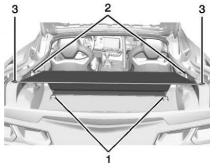
1. Fixer les boucles de plastique sur le couvercle aux fixations du plancher (1) et sur les panneaux latéraux (2).
