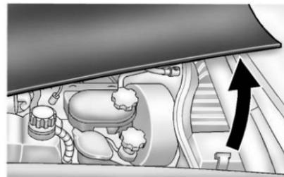
2. Aller sur le côté du véhicule et soulever le rebord arrière du capot, près du pare-brise.
