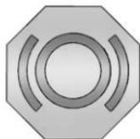
Le réservoir du maître-cylindre de freinage est rempli de liquide de frein DOT 3 approuvé par GM comme indiqué sur le bouchon du réservoir. Consulter *Vue d'ensemble du compartiment moteur* ⇨ 253 pour connaître l'emplacement du réservoir.
