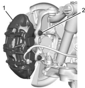
9. Poser l'étrier (1) avec deux fixations (2). Serrer au couple de 120 N•m (89 lb ft).
