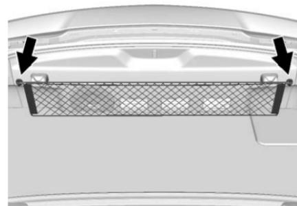
Le véhicule peut être équipé d'un filet de commodité à utiliser pour les petites charges. Fixer le filet aux crochets à l'arrière de la zone de rangement. Ne pas utiliser le filet pour ranger des objets lourds.
