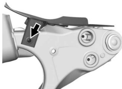
10. Poser le déflecteur de bras de suspension sur la conduite supérieure à l'aide d'une vis. Ne pas serrer à cette étape.
