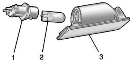
3. Tourner la douille d'ampoule (1) dans le sens inverse des aiguilles d'une montre pour la retirer du bloc d'éclairage (3).
