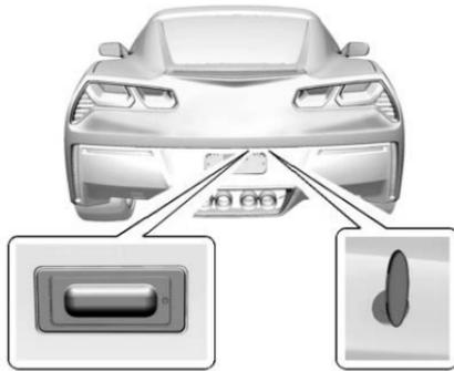
Appuyer sur le patin tactile de déverrouillage du hayon/coffre avec l'émetteur RKE à portée ou utiliser la clé dans le barillet de serrure. Se reporter à *Clés* ⇨ 27.
