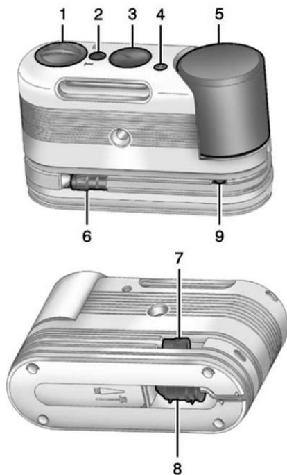
1. Commutateur (Produit d'étanchéité/Air ou air seulement).
