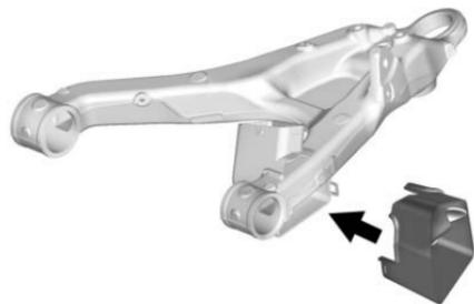
8. Positionner le caisson d'air arrière et clipser les languettes en place dans le caisson d'air avant autour du bras de suspension inférieur.
