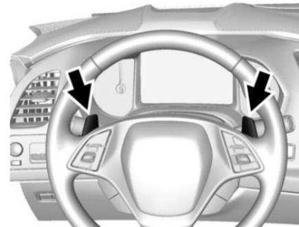
La fonction Active Rev Match (ARM) contribue à un passage souple des rapports en accordant le régime moteur au rapport suivant sélectionné. Le système est activé et
