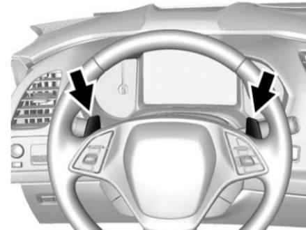
Le système est activé et désactivé en appuyant sur les palettes marquées REV MATCH au volant. Le système doit être activé à chaque niveau cycle d'allumage.
