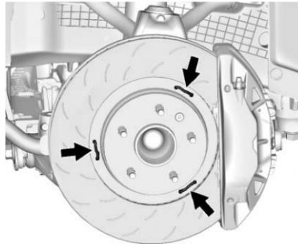
5. Placer le fil en U à travers les trous dans l'anneau de refroidissement de disque.
