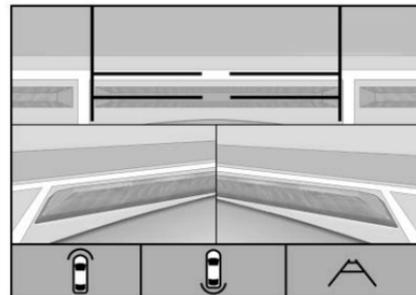
Si le véhicule en est équipé, la caméra avant se trouve devant les affichages de véhicule sur l'écran d'infodivertissement. L'écran affiche une vue avant du haut et du bas sur le haut et des images de caméras avant gauche et droite sur le bas.
