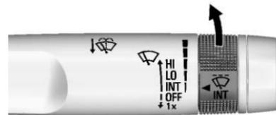
**INT** : Déplacer la manette vers le haut sur INT pour des balayages intermittents, tourner alors la bague ☺ INT vers le haut pour des balayages plus fréquents ou vers le bas pour des balayages moins fréquents.
