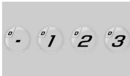
Lorsque le levier sélecteur en position D (Conduite), appuyer sur la palette plus (+) ou la palette moins (-) pour placer la boîte de vitesses en mode de changement de rapport manuel par palette temporaire. Le témoin de rapport de vitesse sur le combiné d'instruments et sur l'HUD affichera un M, même si le levier sélecteur est toujours en position D (Conduite). Pour quitter le système, maintenir la palette plus (+) pendant plus d'une seconde. Le système revient automatique-
