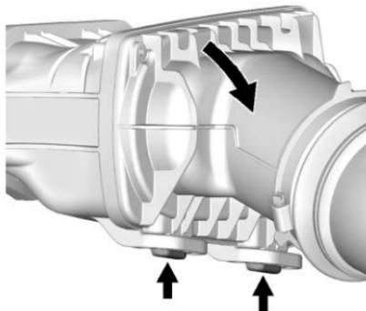
5. Faire tourner le capuchon de filtre à air/filtre vers le bas et désengager les onglets de montage inférieur des fixations de charnière de retenue inférieures. Introduire complètement les onglets de montage de capuchon d'extrémité inférieure dans les fixations de charnière de retenue de logement avant de faire tourner le capuchon vers le haut et de remplacer les vis.
