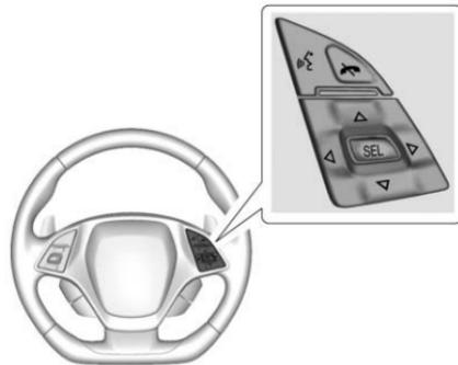
Utiliser la commande au volant du côté droit pour ouvrir et faire défiler les différentes options et les différents affichages.
