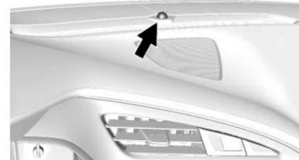
Un capteur de lumière est sur le haut du tableau de bord. Ne pas recouvrir le capteur, sinon, les phares s'allument quand ils ne sont pas nécessaires.
