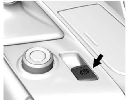
Le véhicule possède un frein de stationnement électrique. Le commutateur se trouve sur la console centrale. L'EPB peut toujours être activé, même si le contact est coupé. Pour éviter de décharger la batterie, éviter les cycles répétés de la fonction EPB lorsque le moteur ne tourne pas.
