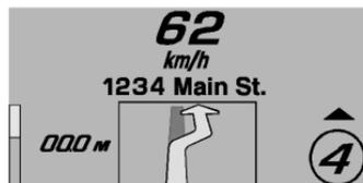
**Navigation** : L'information de navigation pas à pas peut s'afficher lorsque la navigation est active et qu'une manœuvre va s'avérer nécessaire. S'affiche jusqu'à la fin de la manœuvre est achevée puis le HUD retourne à la vue précédente.
