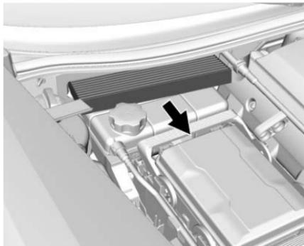
3. Déposer le filtre et installer le filtre à air neuf.
