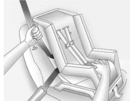
6. Pour serrer la ceinture, pousser sur le siège d'enfant, tirer la sangle thoracique de la ceinture pour serrer la sangle abdominale de la ceinture et rembobiner la sangle thoracique dans l'enrouleur. Lors de l'installation d'un siège d'enfant face à la route, il peut être utile d'utiliser le genou pour pousser sur le siège d'enfant lors du serrage de la ceinture.
