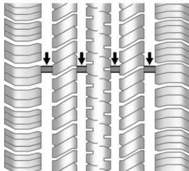
Des témoins d'usure des sculptures sont une façon de signaler qu'il est temps de remplacer les pneus. Les témoins d'usure apparaissent quand
