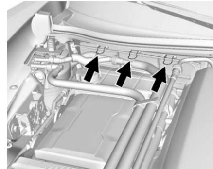
1. Relâcher les pincettes du couvercle de filtre d'habitacle. Les flexibles PVC doivent parfois être écartés brièvement pour accéder au couvercle du filtre à air ;
