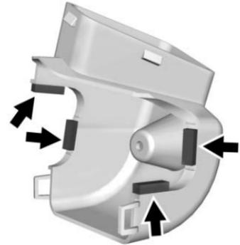
6. Déposer le ruban adhésif des patins en caoutchouc et les poser sur le caisson d'air arrière comme illustré. Lisser sécher 5 minutes.
