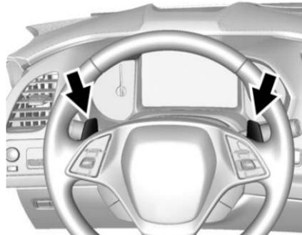
Le système de changement de vitesse manuel par palette peut être utilisé en D (conduite) ou M (mode manuel). Le système est activé en enfonçant la palette gauche pour rétrograder et la palette droite pour passer au rapport de vitesse supérieur. Le rapport de vitesse actuel sera affiché sur le combiné d'instruments ou sur l'affichage à tête haute (HUD), si le véhicule en est équipé.
