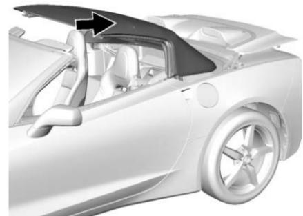
2. Lever et faire pivoter le toit amovible vers l'arrière en position de rangement complet.
