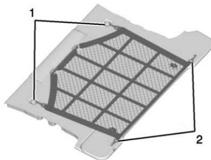
Selon l'équipement, déplier le filet de marchandises et fixer les crochets avant (1) aux fixations avant dans la zone de chargement. Tirer le filet par dessus les éléments chargés sur le plancher et fixer les crochets arrière (2) aux fixations arrière.
