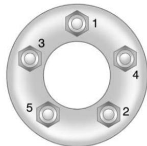
Serrer les écrous de goujon de roue fermement, en croix. Se reporter à *Capacités et caractéristiques* ↪ 350.
