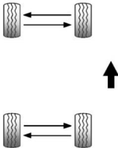
Utiliser ce schéma de rotation si le véhicule dispose de pneus de taille différente à l'avant et à l'arrière.
