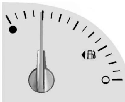
Lorsque le contact est mis, la jauge de carburant indique la quantité approximative de carburant restant dans le réservoir.
