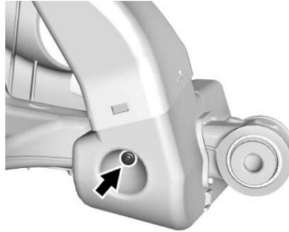
12. Poser les deux vis auto-taraudeuses sur le bras de suspension en passant par les deux côtés des cavités de caisson d'air. Ne pas serrer à cette étape.
