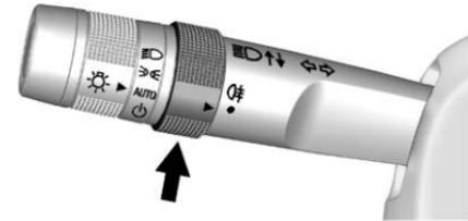
Tourner l'anneau jusqu'à
