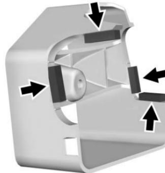
5. Déposer le ruban adhésif des patins en caoutchouc et les poser sur le caisson d'air avant comme illustré. Lisser sécher 5 minutes.
