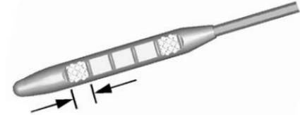
Si le niveau d'huile se trouve en dessous de la zone hachurée sur l'embout de la jauge et que le moteur a été arrêté pendant au moins 15 minutes, ajouter 1 l (1 qt) d'huile préconisée et revérifier le niveau. Consulter « Sélection de l'huile moteur correcte » plus loin dans cette section pour obtenir des explications sur le type d'huile à utiliser. Pour connaître la capacité d'huile du carter-moteur, voir *Capacités et caractéristiques* ⇨ 350.
