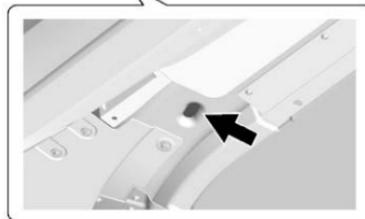
Utiliser uniquement un cric d'atelier avec patin de levage de 64 mm de diamètre (2,5 po) ou moins et suffisamment épais pour que le cric n'entre pas en contact avec la carrosserie du véhicule.
