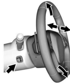
Appuyer sur la commande pour déplacer le volant de direction en position d'inclinaison ou télescopique vers le haut et le bas ou vers l'avant et l'arrière.
