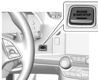
Le véhicule est équipé d'un bouton-poussoir de démarrage électronique sans clé.
