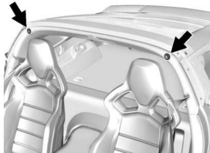
5. Positionner le bord arrière du panneau de toit suivant sur le caoutchouc d'étanchéité situé à l'arrière de l'ouverture du toit.
